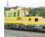
軌道検測車 「EM30」 軌間、水準、高低、通り、 平面性を検測します。
